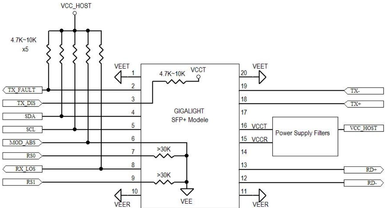
Figure4. Host-Module Interface
